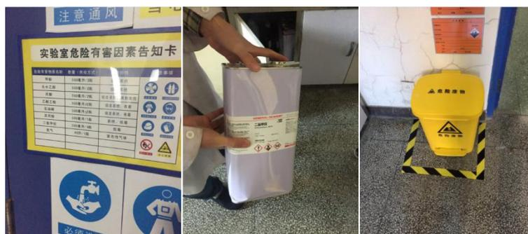
催化楼 408 实验室化学品储存在试剂架等合规处，没有在窗台、地面、通风柜下层随意堆放的情况。易制毒、易制爆化学品专柜上锁保存，个别需要低温保管的试剂保存在经过防爆改造的冰箱内。此外，为了对溶剂进行纯化和安全使用，设置了有机溶剂净化系统一套。
